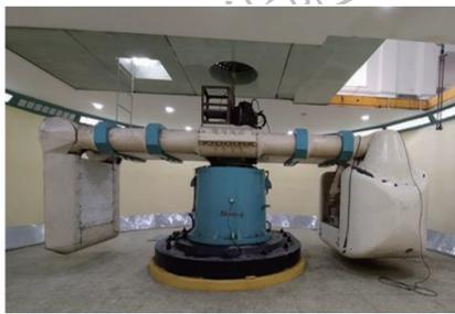
图3 LXJ-4-450大型土工离心机
