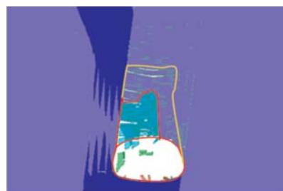
图 7 无支护情况下隧道围岩的变形云图
