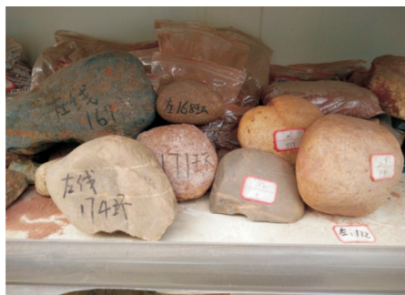
图3 左线隧道复合地层碴样
